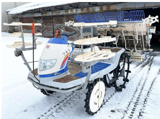
イセキ田植機 型 式：PZ60 条 数：6条（補助車輪・箱施用剤散布機付） 使用時間：269h（未整備） 保管場所：東平田倉庫
