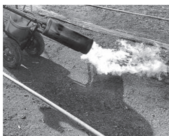
図3. 灯油式バーナーで地表面を焼却
