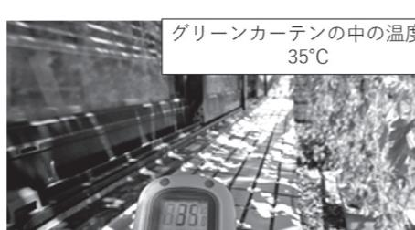
写真4. グリーンカーテンの中のブロック表面温度(35°C)
